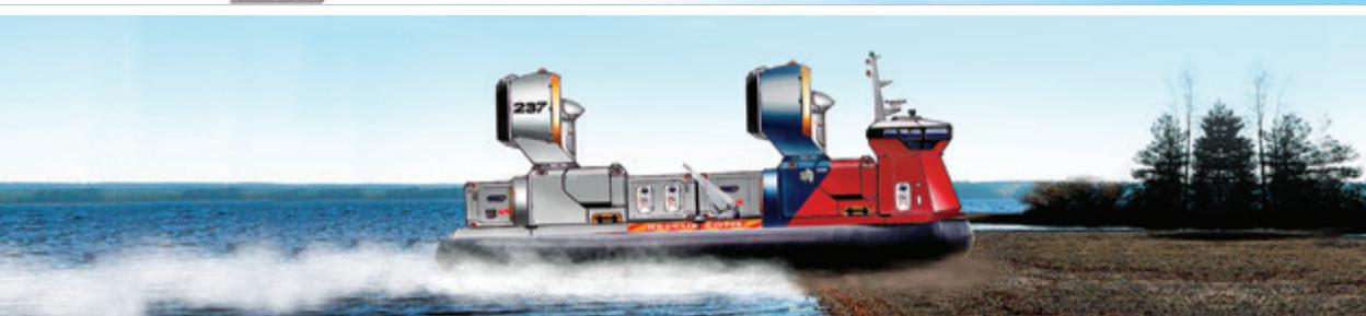
Разработан концептуальный проект научно-исследовательского судна на воздушной подушке (НИСВП), являющегося унифицированным амфибийным плавсредством для размещения контейнеризованных лабораторий и оборудования для выполнения инженерно-геологических изысканий, геолого-геофизических, биологических, экологических и др. исследований в переходной зоне «суша-море».
