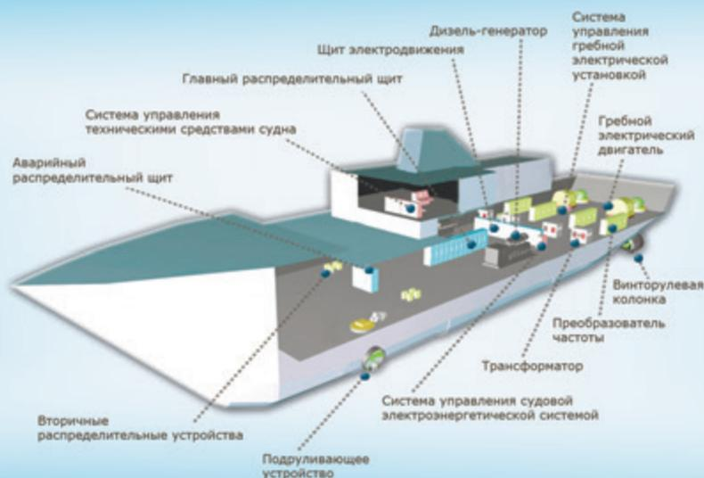
Осуществляем разработку, изготовление, испытание и поставку комплектов электрооборудования для единых электроэнергетических систем (ЕЭЭС) с гребными электрическими установками (ГЭУ).
