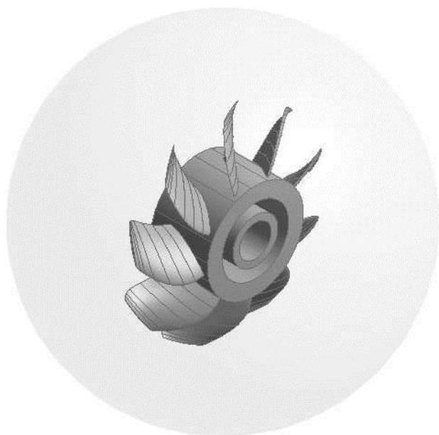
Рис. 4.11. Геометрия расчетной области «мокрого» РК с лопастями из сплава Д16
