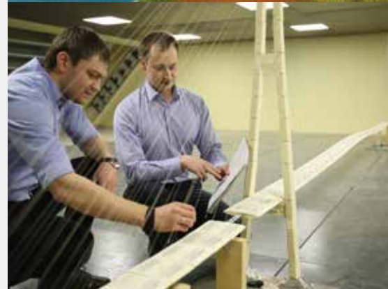
Упругоподобная модель пилона моста через Босфор Восточный в аэродинамической трубе
