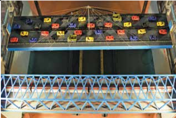
Исследование взаимодействия расположенных рядом автомобильного и железнодорожного мостов
