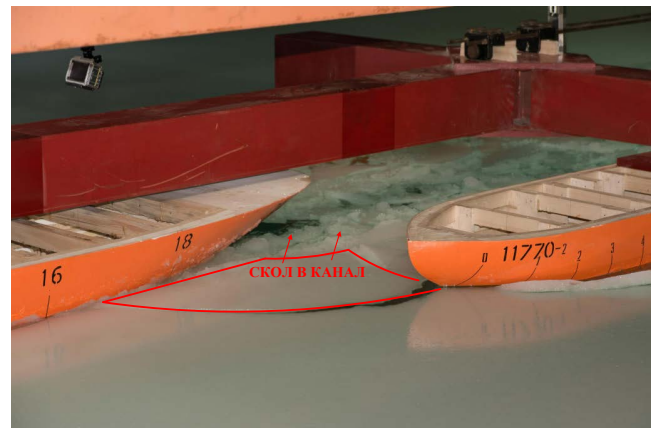
Рисунок 10 – Сравнение результатов расчетов ледового сопротивления многокорпусного ледокола и данных модельного эксперимента в ледовом бассейне (а) и фрагмент модельного эксперимента (б)
