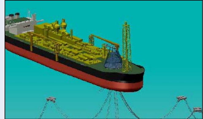
Ледостойкая платформа для газоконденсатных месторождений в условиях дрейфующих льдов и айсбергов
